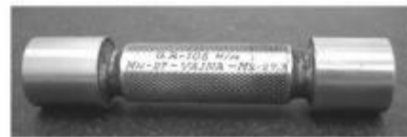
Calibre de límites cilíndrico Pasa-No Pasa. Cortesía de Sidenor S.A - Reinoso.
