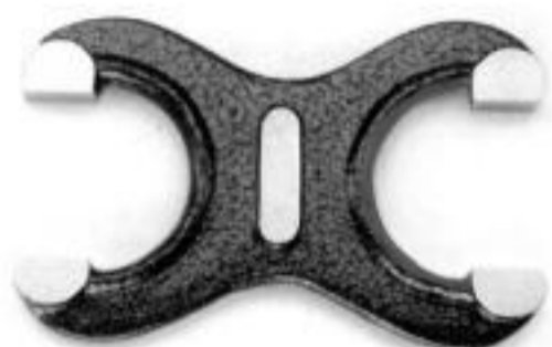
Calibre de límites fijo. (Herradura 2 bocas: Pasa-No Pasa.)
