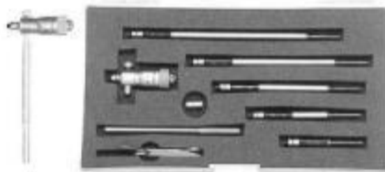
Micrómetro de interiores con alargadera - Mitutoyo.
